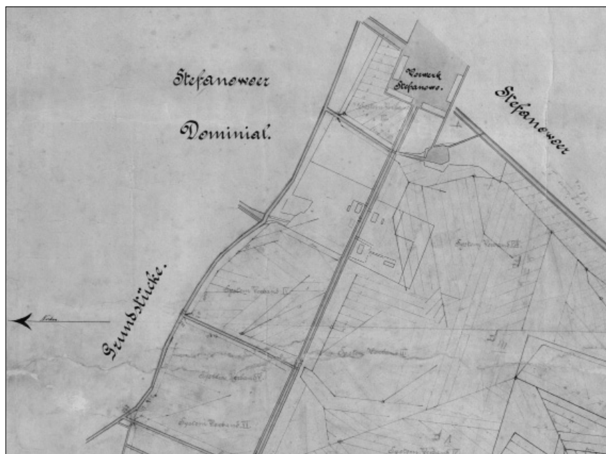
Ryc. 3. Fragment mapy pól folwarku Stefanowo z 1879 r. w skali 1:2500, z rysunkiem rowów melioracyjnych poprowadzonych przez pola i wzdłuż dróg. Pomniejszona. Sygn. AN 3824
