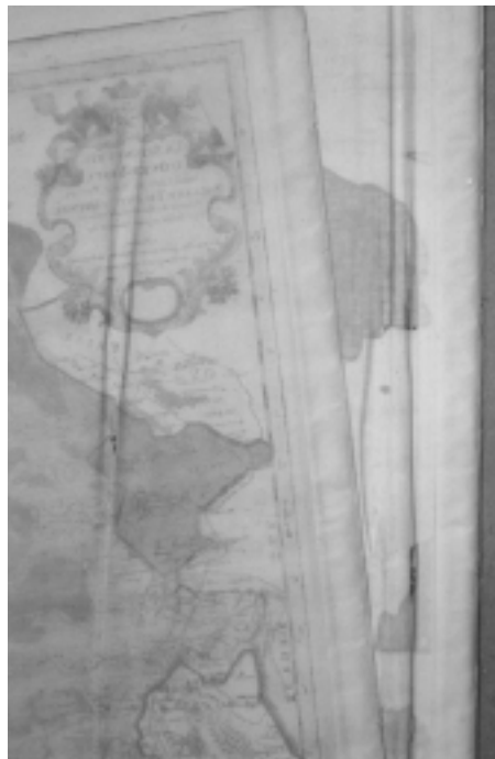
Ryc. 10. Odwrocia map pochodzących z Atlas Nouveau N. Sansona z 1694 r. W miejscach zagięć przebiegających przez obszary pokryte grynszpanem widoczne są uszkodzenia papieru – pęknięcia i ubytki (fot. autorki)
