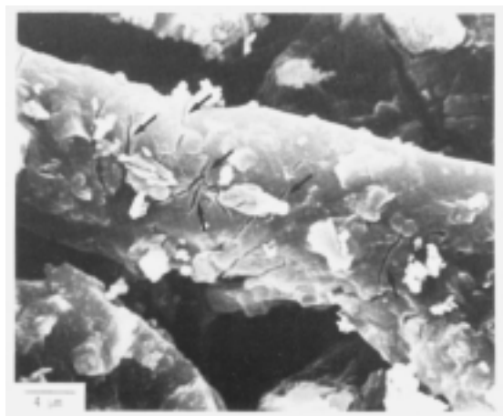
Ryc. 1. Zdjęcie (REM) włókna celulozowego pobranego z obszarów pokrytych pigmentem miedziowym, charakteryzujących się wysokim stopniem zniszczeń. Widoczne są poprzeczne rysy na włóknach. (Według Banik G., Stachelberger H., Mairinger F., Untersuchungen zum Abbau... , op.cit., s. 345)
