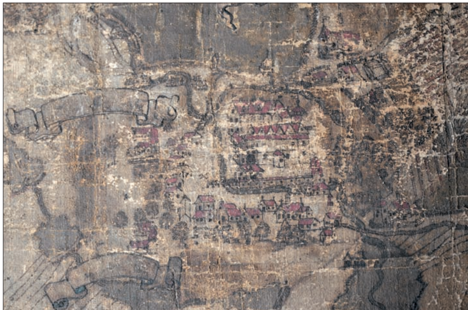
Ryc. 4. Zbliżenie fragmentu mapy z przedstawieniem zabudowań Pszczyny. Widoczne ingerencje – zniszczenia papierowego podłoża wynikające z prób mechanicznego usunięcia wcześniejszych informacji. Ponownie naniesione media cechuje już niższa adhezja do zdegradowanego podłoża (fot. Jolanta Czuczko)
